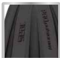
Water channels. Canalisateurs d'eau.
